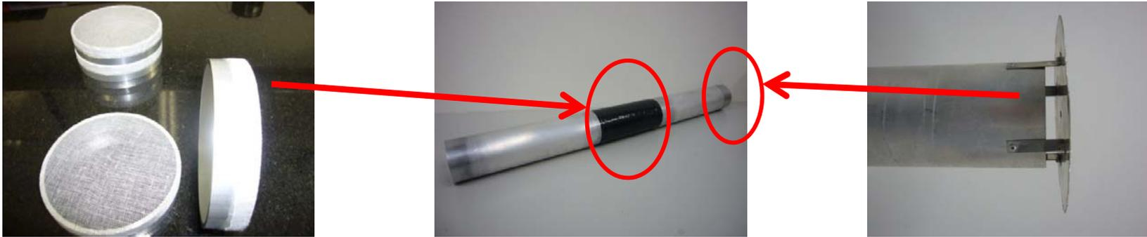
外径100mm, 内径96mm, 厚さ20mmのリング10個を連結
