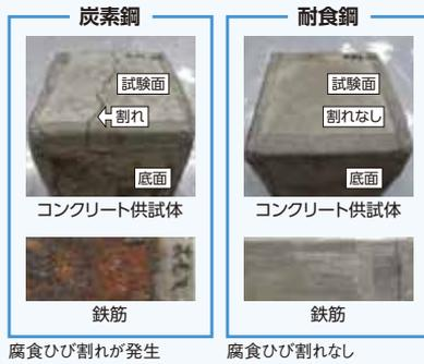
ASR\*2劣化させたPC試験桁の暴露試験
