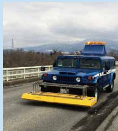
車載型高速スキャンレーダーによる床版内部の診断
