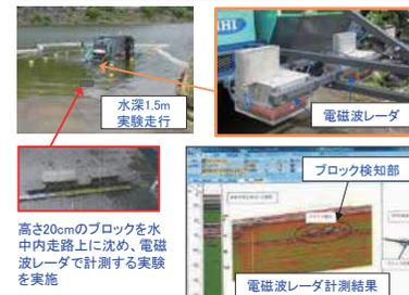
高さ20cmのブロックを水中内道路上に沈め、電磁波レーダで計測する実験を実施
