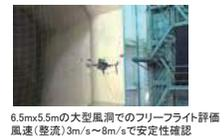
6.5m x 5.5mの大型風洞でのフリーフライト評価
