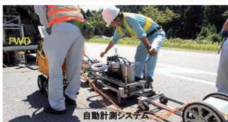
④ FWDと組み合わせたハイブリッド計測システム
