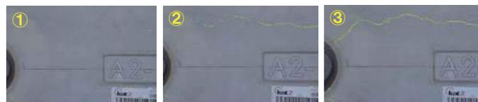
※ トンネルセグメント加圧破壊試験での経過時間(分単位)別データ。
