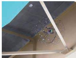
橋梁の桁間に入り点検するドローン(直径0.95m、重量2.5kg)
