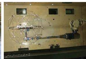
風洞での空力性能試験
