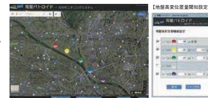
衛星画像処理ツールによる堤防天端高変位量の把握(イメージ)
