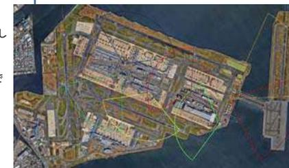
羽田空港全域のモニタリングに必要なGB-SAR装置の配置図
