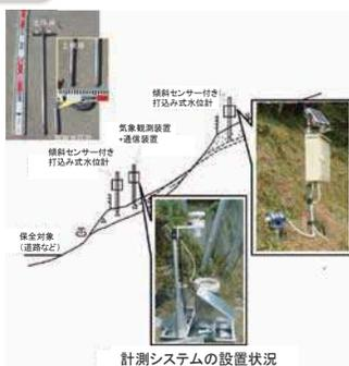
・雨量、間隙水圧、傾斜のそれぞれの状況の同時計測を実現
