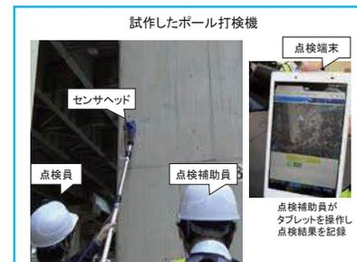
試作したボール打検機
