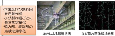
・正確なひび割れ図を自動作成
